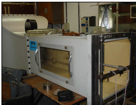
Figura 3-37. Túnel de vento utilizado para calibração dos anemômetros
