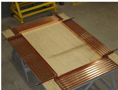
Figura 3-7. Composição da cavidade com serpentinas aplicadas na face externa (peças laterais)
