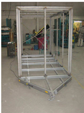
Figura 3-16. Estrutura do trailer (perfis metálicos)
