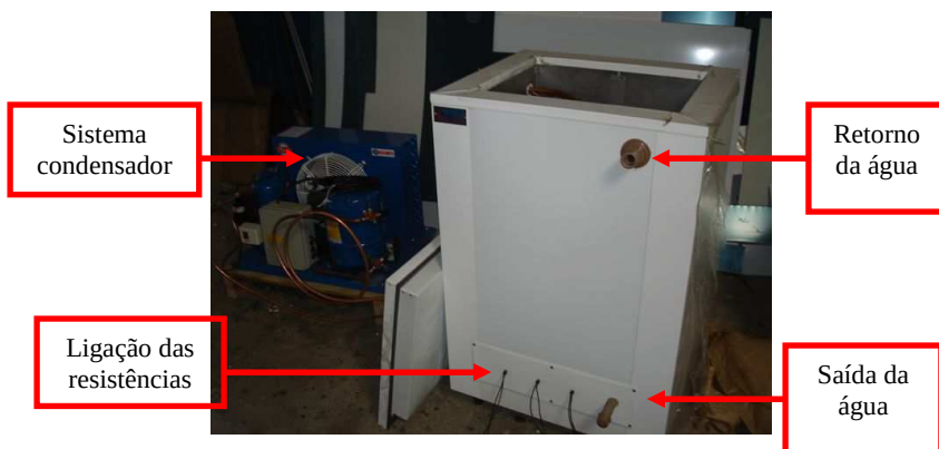
Figura 3-15. Vista geral do banho térmico
