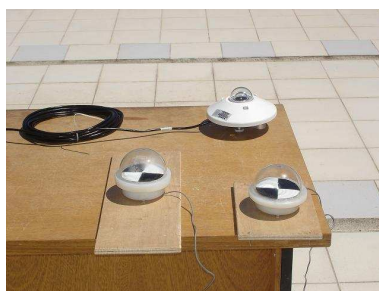
Figura 3-34. Configuração da calibração dos piranômetros
