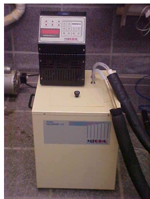
Figura 3-4. Banho termostático para a cavidade secundária
