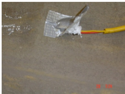
Figura 2 – Colocação dos termopares nas superfícies interna e externa das telhas.
